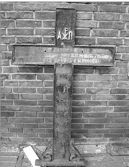
Het voormalige grafkruis is ontdaan van de meeste ingegoten teksten en ornamenten en zal gestraald worden om het te ontdoen van roest en verfresten.
